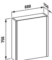
Placard de toilette avec miroir, aluminium, 2 portes miroir doubles avec 2 éléments d'éclairage LED, réglable
