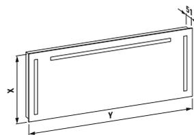
Miroir avec 2 éléments d'éclairage verticaux, 230V, IP44
