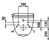
Raccordement avec système d'installation LAUFEN LIS CW2
