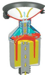
Das LAUFEN lema **0-Liter-Urinal** spart Wasser und Kosten. Es funktioniert ohne Wasser und benötigt weder eine Wassersperre noch Elektrizität, um den Abfluss geschlossen zu halten. Der Urin selbst hilft die Gase einzuschliessen und verhindert ihr Ausströmen. Das Prinzip dieser «Falle» ist in der chemischen Industrie als Erlenmeyer-Gefäss bekannt.
