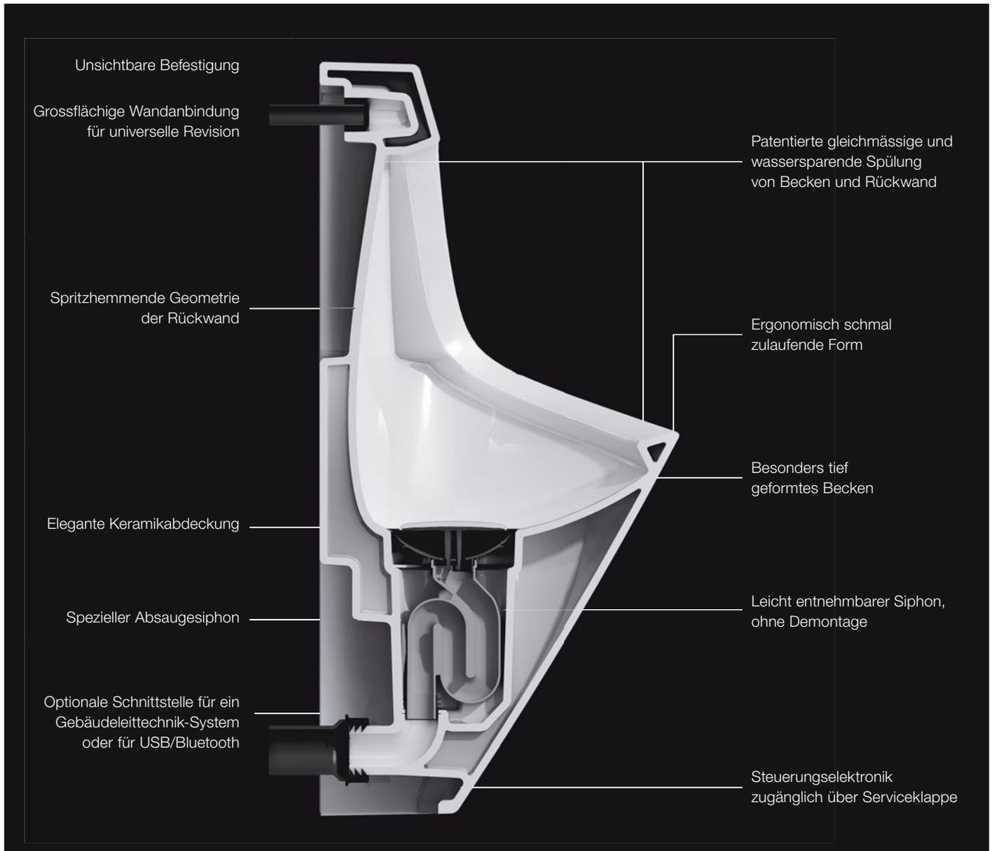
Urinale von LAUFEN werden den Unterhalt und die Wartung von öffentlichen Sanitäranlagen revolutionieren. Bisher mussten Urinale beim Wechsel des Siphons häufig komplett demontiert werden. Bei Antero und Lema lässt sich der Siphon einfach mit einem Spezialschlüssel lösen und herausheben.
